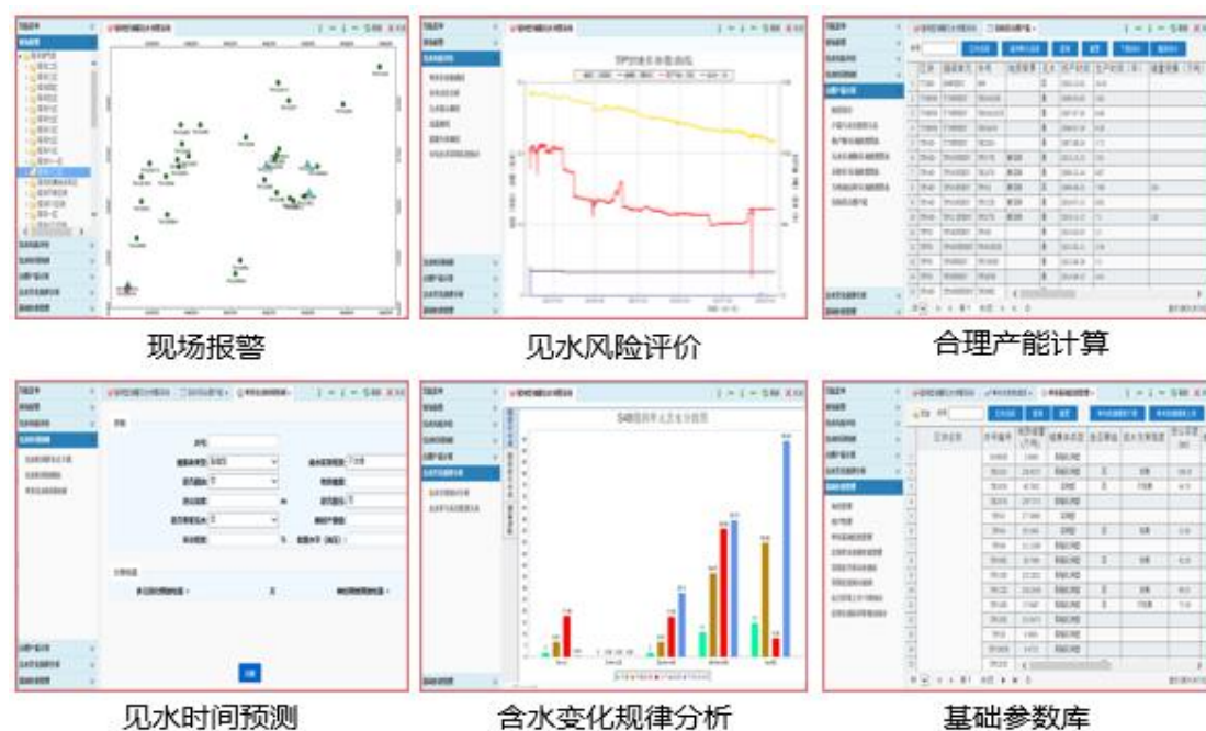
井筒监测见水预警系统的六个模块（华线软件界面）
